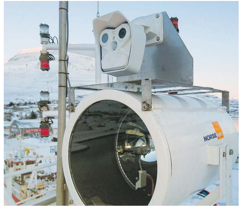
■ Hitamyndavél fest á hreyfanlegan leitarkastara, nýtir það sem fyrir er til að beina vél og ljósi.
