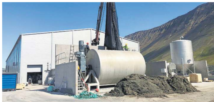
■ Þvottavél fyrir fiskeldispoka við nýtt þjónustuverkstæði Hampiðjunnar á Ísafirði sem tekið var í notkun árið 2022.
