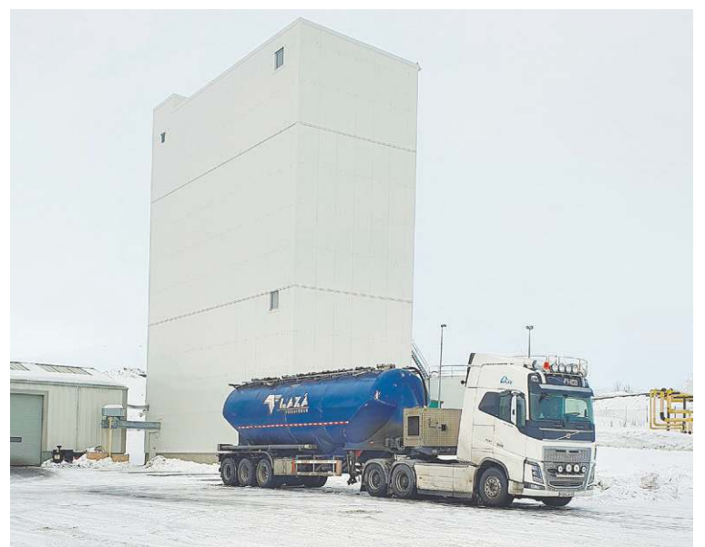
■ Mikil hagræðing fólst í því bæði fyrir fódurframleiðandann Laxá og fódurnotandendur þegar byrjað var að flytja fóðrið á notkunarstað í tankbil og dæla því í siló við eldisstöðvarnar.
